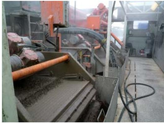
*Séparation par vibration des «cuttings» (roche) de la boue de forage*
