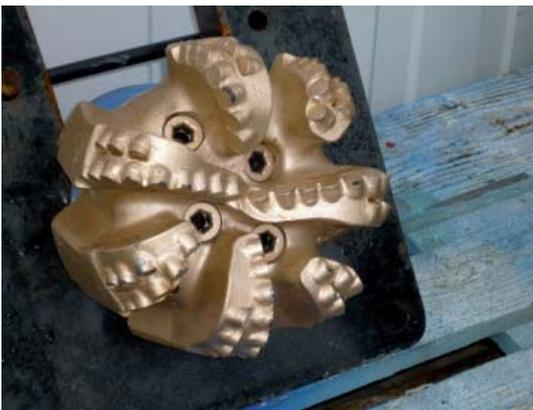
*Trépan de forage avec inserts diamantés pour roches dures*
